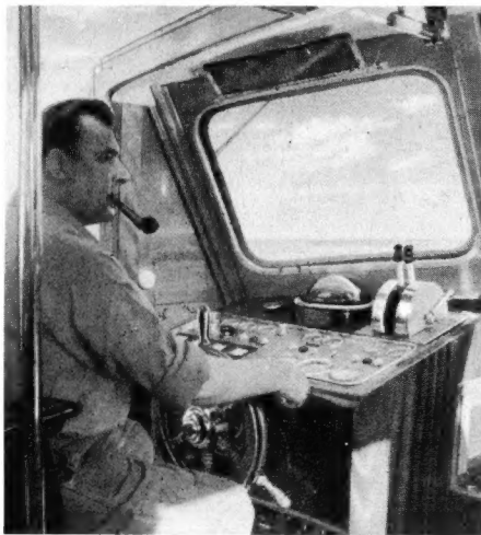
Bild 3. Steuerstand des Funkversuchsbootes mit den seemannischen und maschinentechnischen Einrichtungen. Außer nach dem Magnetkompaß, dessen Glaskalotte unterhalb des Fensterrahmens zu sehen ist, kann auch blind nach Funkpeilung im Kopfhörer ein stabiler Kurs gesteuert werden
